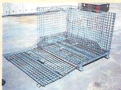
②側面網を内側へ折りたたんで 裏面網まで移動させる。
